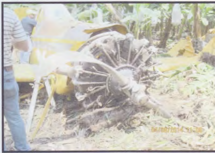
Fotografía No. 20 Daños Parte Frontal Ala Izquierda
