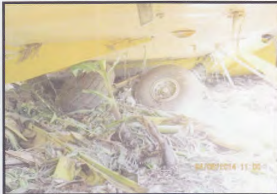
Fotografía No. 9 Daños en el Tren de Aterrizaje
