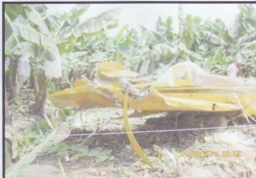
Fotografía No. 8 Plano o Ala Derecha Dañada
